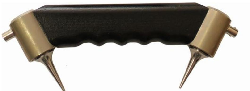
Рисунок 4 – Общий вид ПУЛЬСАР-2.2
