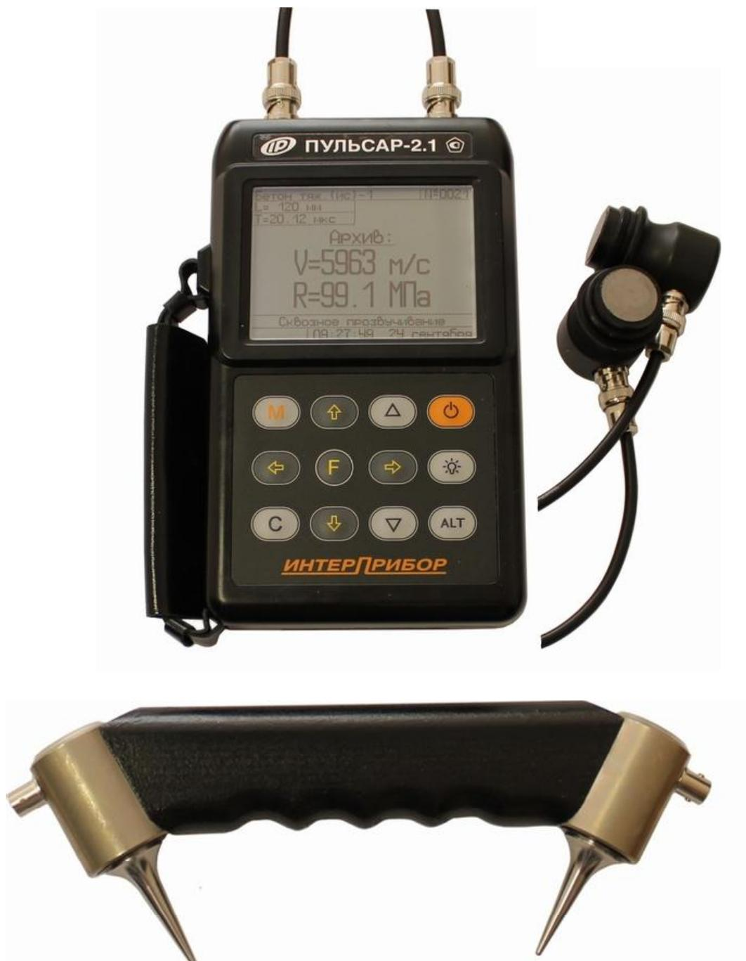
Рисунок 3 – Общий вид ПУЛЬСАР-2.1
