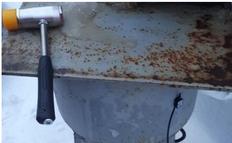
Рисунок 4 – Пример применения бокового датчика ВД-1002.02
