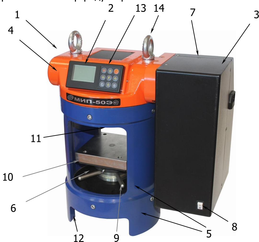
Рисунок 1 – Общий вид приборов модификаций МИП-25Э и МИП-50Э.
