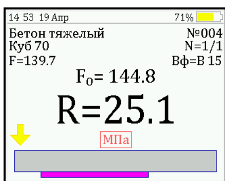
Останов мотора мигающий указатель «↓»
