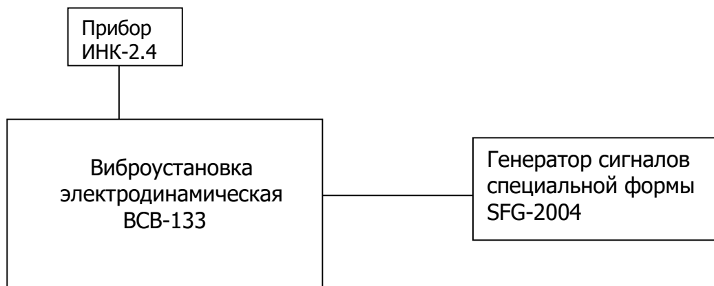
Рисунок 4 – Схема измерения амплитуды виброперемещения
