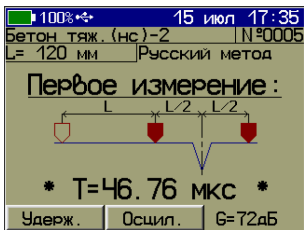
«Русский метод» измерения глубины трещины
