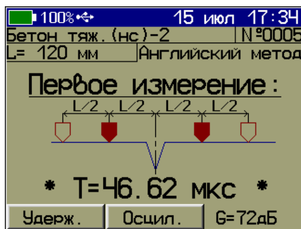
«Английский метод» измерения глубины трещины
