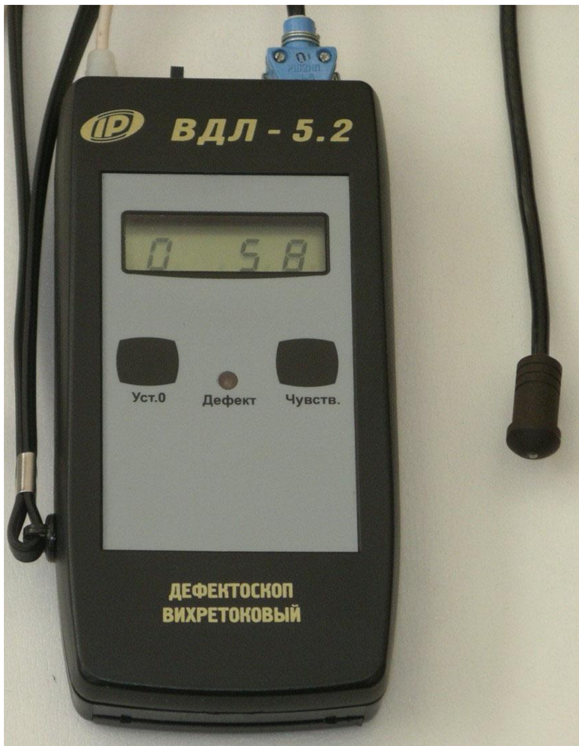
Рисунок 1 - Внешний вид прибора ВДЛ-5.2
