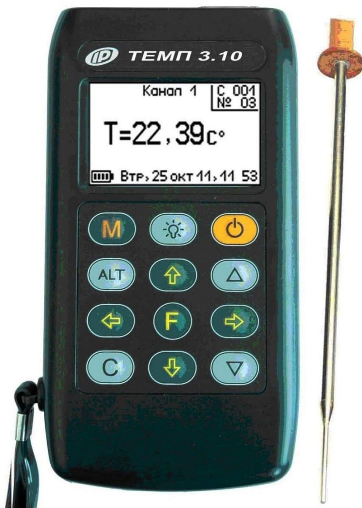
Рисунок 1 – Общий вид прибора ТЕМП-3.10 с погружным датчиком температуры ТЗ-С
